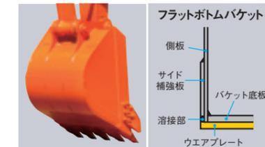
溶接部をウエアプレートで保護するフラットボトムバケットを採用。作業時のならし跡もきれいです。
