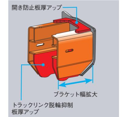
アイドラブラケット開き防止板厚およびトラックリンク脱輪抑制板厚を増加。外方向への開き防止と、トラックリンクおよびローラ類などの足回り部品の耐久性が向上しました。
