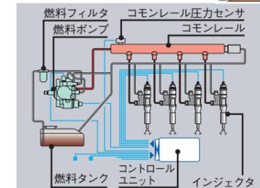
排出ガス3次規制に対応するため採用した新しいタイプの燃料噴射システムです。燃料ポンプを超高圧で駆動し、気筒ごとのインジェクタに燃料を配分して噴射するシステムです。さらに、電子制御により1000分の1秒単位で燃料の噴射タイミング、噴射量をきめ細かに制御。この結果、燃料噴射量の最適化が図れ、高出力化ならびに不完全燃焼によるPM(黒煙などの粒子状物質)の低減や低燃費を実現します。
