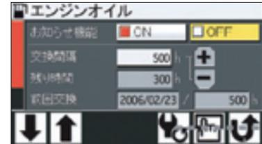
作動油や燃料フィルタの交換間隔を設定し、交換時期になるとモニタにメッセージを表示します。計画的なメンテナンスをサポートします。
