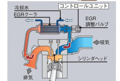
一度燃焼させた排出ガスの一部を吸入空気と混合し、再燃焼させる機構です。燃焼室内の酸素濃度を抑制することとEGRクーラにより燃焼温度を下げることで、高出力を確保しつつ大気汚染物質であるNOx(窒素酸化物)の排出低減と低燃費を実現します。
