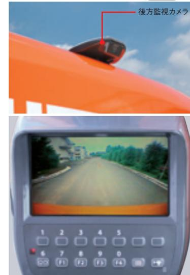
カウンタウイト部に後方監視カメラを搭載。キャブ内のモニターで後方を確認でき、後進時の確認に役立ちます。
