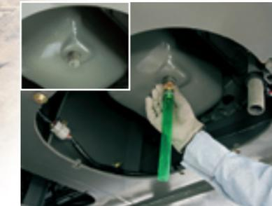
エンジンオイルパンにドレンカバーを装備。備え付けのノズルホースにより、容易にドレン作業が行えます。
