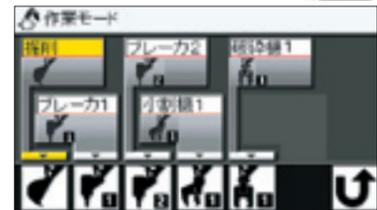
アタッチメント取付け時の煩雑な油圧回路切替えや流量切替は、「作業モード選択」画面からワンタッチ操作で行えるため、ブームや車体上でのバルブ切替作業は不要です。
