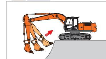
今まで、タンクに戻っていたブーム戻りの圧油をアーム動作に再利用しました。この機構により、掘削時のアーム引き動作のスピードアップが大幅に図られました。
