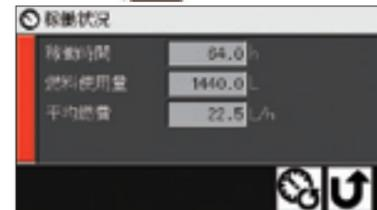
前回行った給油時からの稼働時間、燃料使用量、平均燃費をモニタに表示します。
