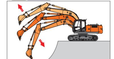
ブーム下げ時のフロントの重さを利用して、圧油をブーム回路内で循環(再生)する機構。この結果、ポンプからの圧油を集中的にアームに供給することができ、アーム/ブーム下げ複合操作時のアーム動作のスピードアップが大幅に図られました。
