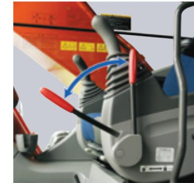
ロックレバーが完全にロックしていないとエンジンが始動できないニュートラルエンジンスタート機構を採用。レバーに触れていることに気づかずエンジンを始動して、急に機械が動いてしまうことを防ぎます。
