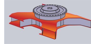
Xビーム構造のボックス寸法拡大や構造改良により、断面性能が最大で45%向上(対従来機ZAXIS)。さらに、上下板には1枚板の曲げ構造を採用しました。溶接部を減らすことで、Xビーム構造の強度および品質が向上しました。
