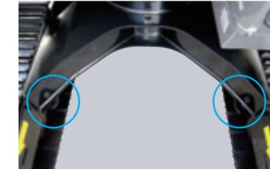
輸送時の機械固定用フック穴をトラックフレームの下フランジ部前後計4ヵ所に設けました。
