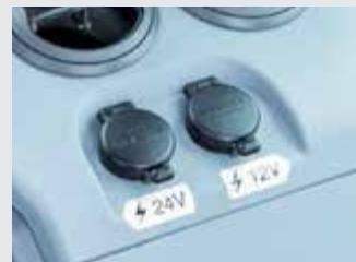
24V電源と 12V電源 NEW
