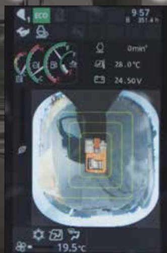
AERIAL ANGLE® 全周囲表示例
