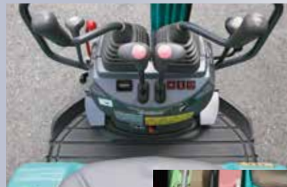
A/Bシフタ切替えレバー搭載位置
