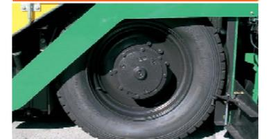
新開発のホイールモータ(ダイレクトドライブ方式)の採用で、高速・低速の切替がスイッチ操作で可能になりました。作業時の安定した低速性と、移動時の機動力も向上しました。(前進3段・後進2段変速)特許取得済
