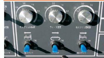
合材自動供給システム使用中も単独制御可能となりました。フィーダとスクリュのスピードコントロールは電磁比例(可変)式とし、作業に最適な搬送量と横送り量が得られます。またスクリュは左右単独・正逆回転操作も可能です。
