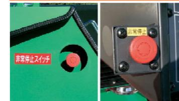
本機は、エンジンを緊急停止する非常停止スイッチを本体左右2ヶ所、運転席操作パネルに1ヶ所設け、安全性を向上しています。
