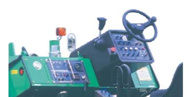
使用頻度の高いスイッチ類を運転席操作パネルに集中配備。また、前後進は走行レバー1本で任意な速度が得られ、安全かつ効率的に舗装作業が行えます。
