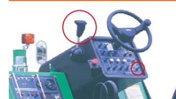
走行レバー及び自動・手動切替スイッチ/作業・走行スイッチ停止がONの時は、エンジンは始動しないシステムになっています。
