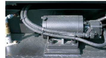
締め固め装置は、油圧式パイブレータ仕様で、合材の種類による締め固めの転圧力を可変する事ができます。
