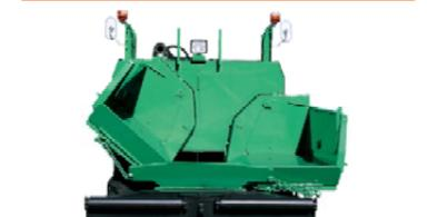
ホッパは2段折畳式で、油圧シリンダによる左右単独操作が可能。舗装現場に合わせて調整ができ、また障害物も避けられ大変便利です。
