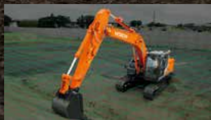
位置情報により掘削面を認識
