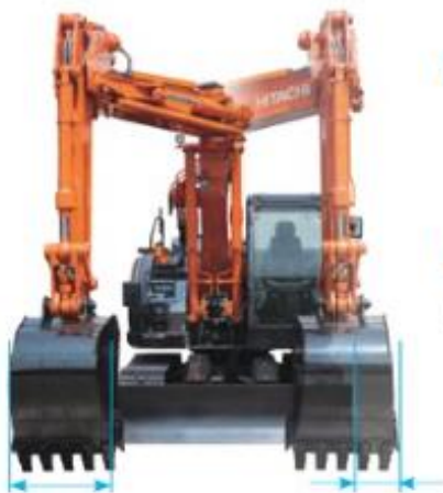
右クローラ外側掘削幅 530 mm
