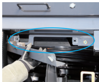
ラジエータ清掃窓
