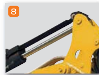
8 ロッド傷つきによる油漏れを防止するシリンダガード
