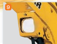
9 作業用ライトを破損の少ないブーム下部にスキリ内装
