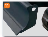
11 大型化された材質に特殊鋼を使い耐久性を高めたブレードカッティングエッジ
