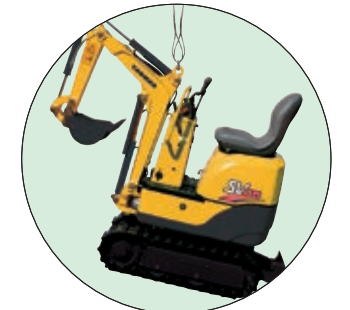
本機一点吊り
