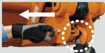
MLクレーン仕様ワンタッチ式クレーンフック格納ピン
